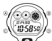
Diese Armbanduhr verwendet ein elektrolumineszentes (EL) Panel, welches das gesamte Display beleuchtet, so dass Sie dieses auch im Dunkeln einfach ablesen können.
